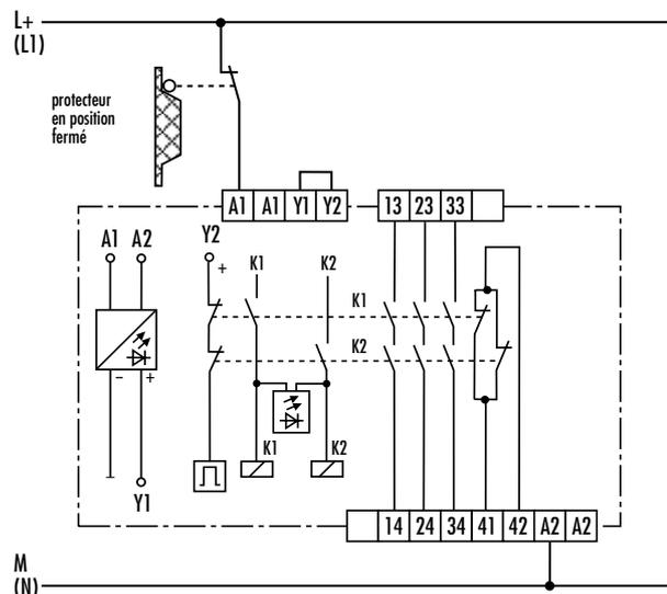
Le contrôle de capot mobile par un interrupteur de sécurité câblé en monocal est conseillé pour répondre aux exigences de la catégorie d'arrêt 0 selon EN 60204-1, et à la catégorie de risque 2 selon EN 954-1. Un défaut de masse dans le circuit de commande de l'interrupteur de position est détecté.
