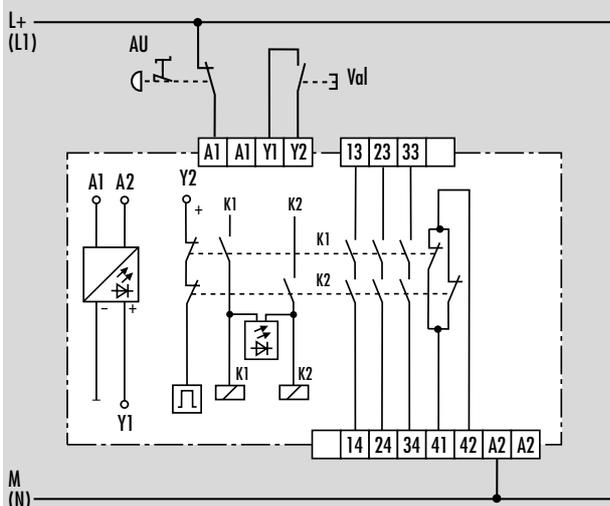
Un circuit d'arrêt d'urgence câblé en monocal est conseillé pour répondre aux exigences de la catégorie d'arrêt 0 selon EN 60204-1, et à la catégorie de risque 2 selon EN 954-1. Un défaut de masse dans le circuit de commande de l'AU est détecté.
